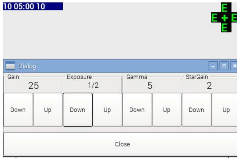
ここでゲイン、露出、ガンマを調整して、星を写し出します。ガイドカメラのピント合わせをしていない場合は、ピントを合わせてください。
