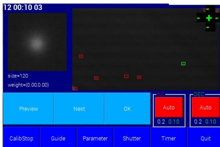
ガイド星の候補が表示されるので、良ければ[OK]ボタンをタップします。何もしなくても7秒後に自動でキャリブレーションが始まります。
